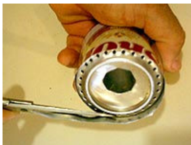
18 - Corte o excesso da lata com a tesoura.
