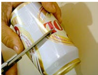
15 - Corte outra lata com 6,5 cm medindo da parte alta do fundo.
